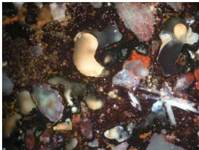
6. kép. Homokkő csiszolati képe, jobb oldalon barittal. A kép szélessége 20 mm.
