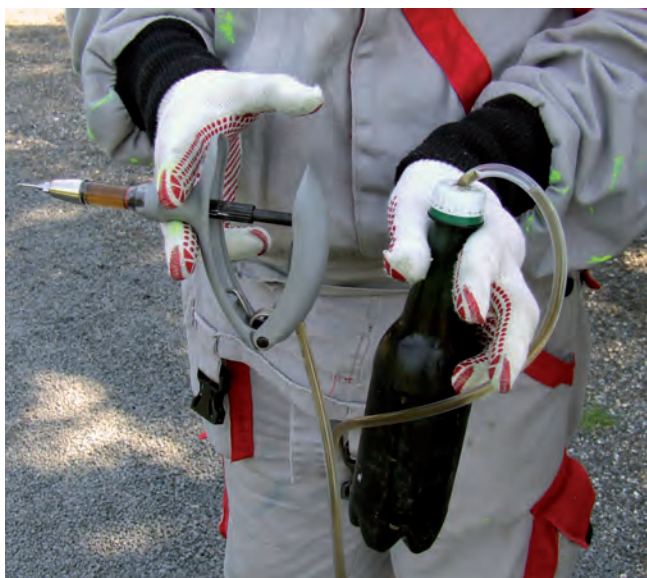
6. ábra. Az injektálásra használt állatorvosi tömegoltó. (Fotó: Kocsis G. I.)
