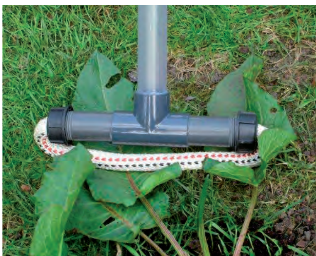
8. ábra. Microwipe eszköz kenéshez (forrás: http://www.marvipak.fi ).
