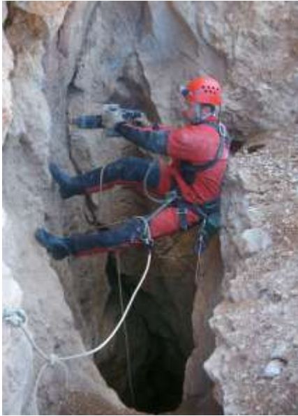
Poligonpont befúrása az akna tetején.
