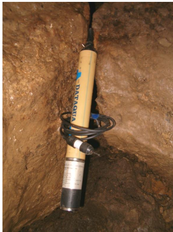
7. fotó: Dataqua radonmonitor
