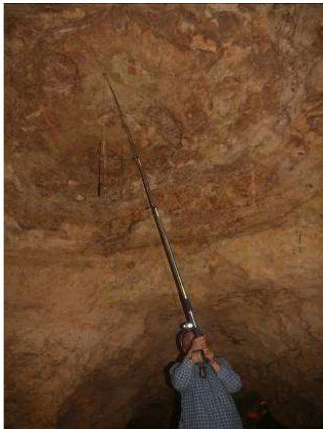
Főtepont levetítése horgász módszerrel a Lóczy-teremben
