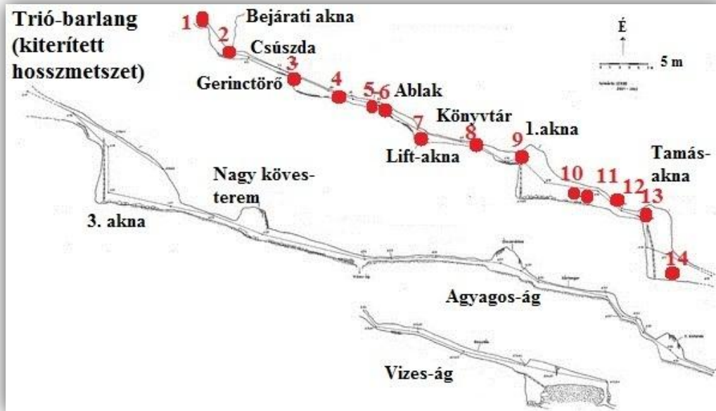
21. ábra: Szenzortérkép ábrázolása a kiterített hosszmetseti tréképen Barlangtérkép forrása: SZKBE 2001-2002, alapján saját szerkesztés
