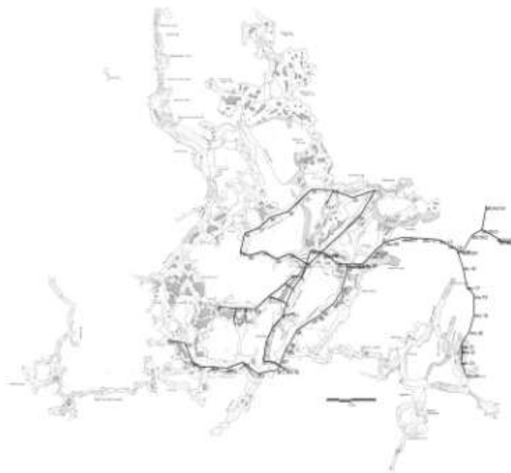
A GPS poligon illesztése a barlang alaprajzára
