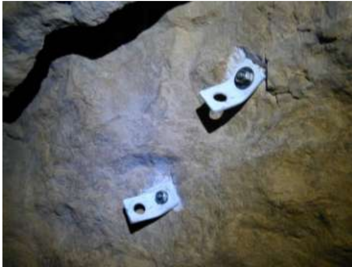
Két bevizsgálatlan acélfül a Tűzoltó-ág átjárójának elején
