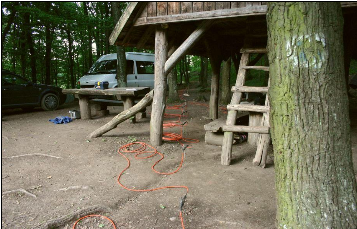
5. fotó: Ez esőbeálló alatt vezetett szondasor (narancsárga kábel köti össze a szondákat)
