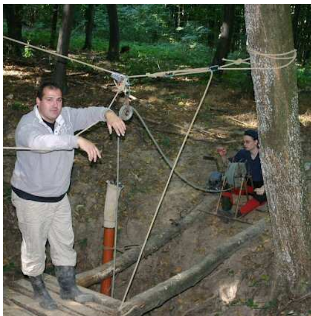
A Borjukúti-felszakadás kitisztított alja és a felszíni csörlőállás (Fotó: Pék J., Borteleki G.)
