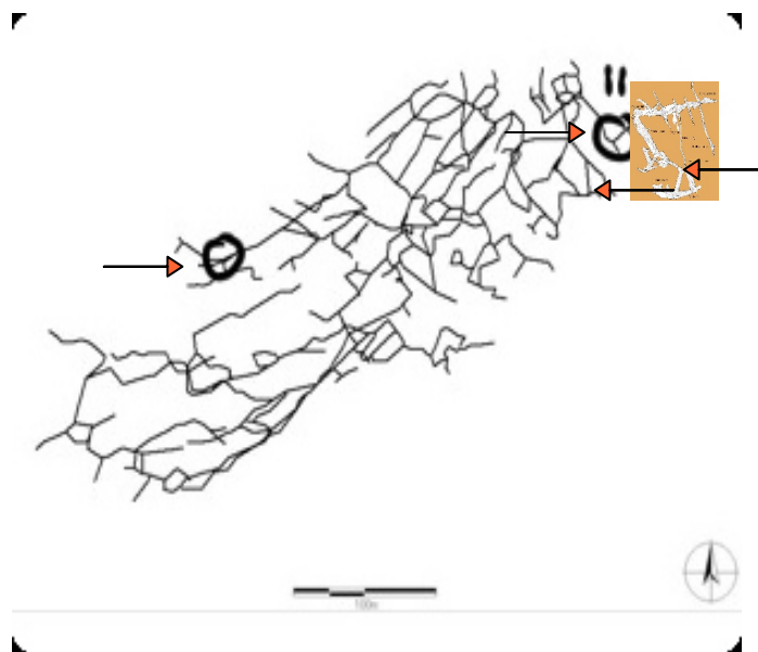
5. ábra A mintavételi pontok ábrázolása a Molnár János-barlang aktuális feltárásokkal kiegészített poligonrajzán. A térképre viszonyításképp ráhelyeztem az 1. ábrán bemutatott alaprajzot. A sötét karikák víz alatti pontokat jelölnek. (Forrás: Storozyński Szabolcs)
