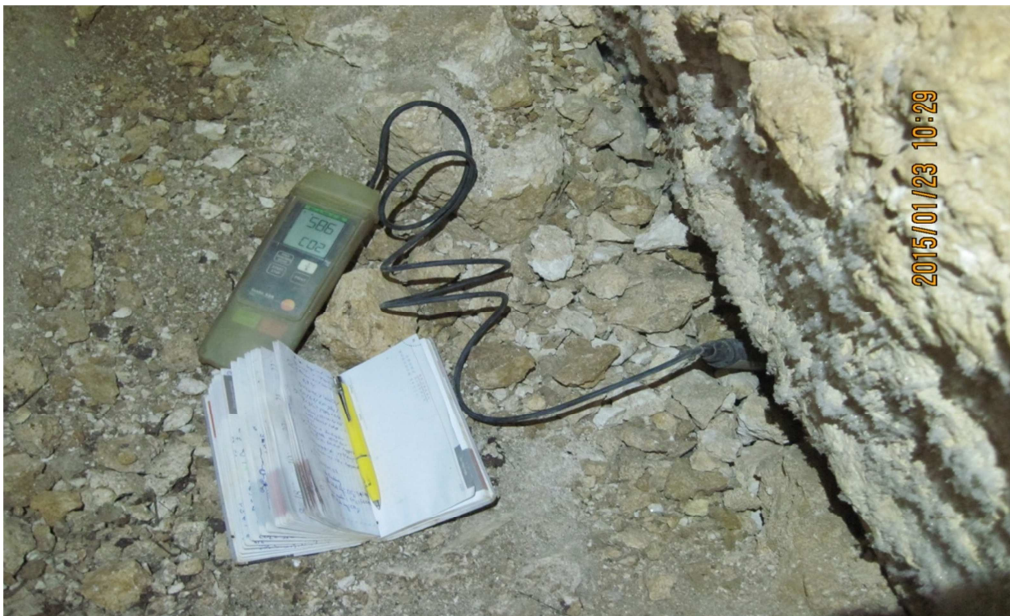
1. sz. fotó: a DNY-i oldalág munkagödrének alján a repedések közt tűnik el a hideg felszíni levegő. A levegő útját CO2 méréssel is követni tudjuk. A jobb oldali falon jégkristályok rakódtak le (fotó: Stieber Bence).
