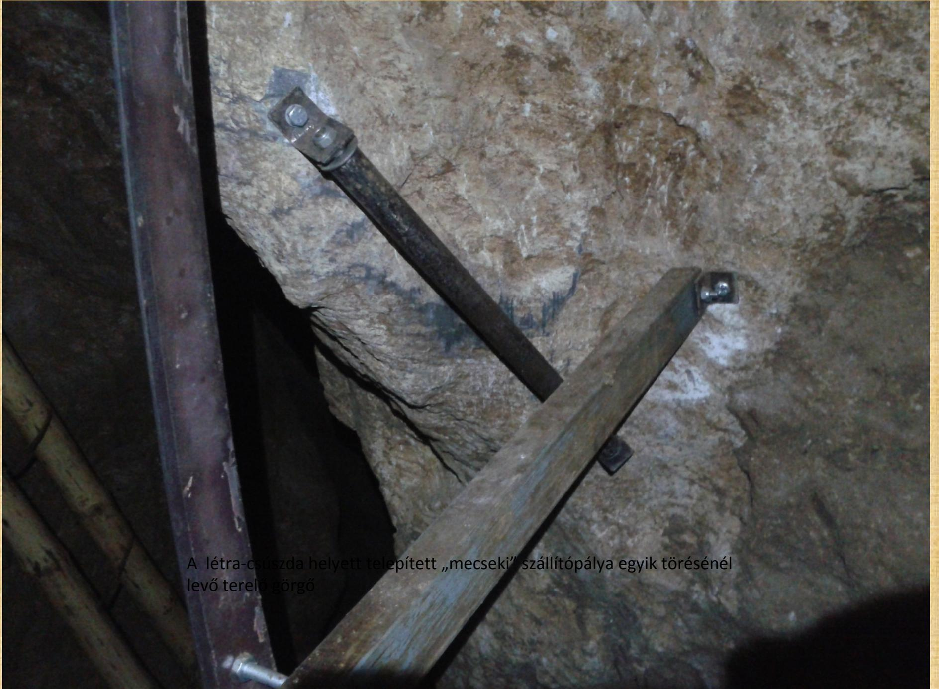
A létra-csuszda helyett telepített „mecseki” szállítópálya egyik törésénél levő terelő görgő
