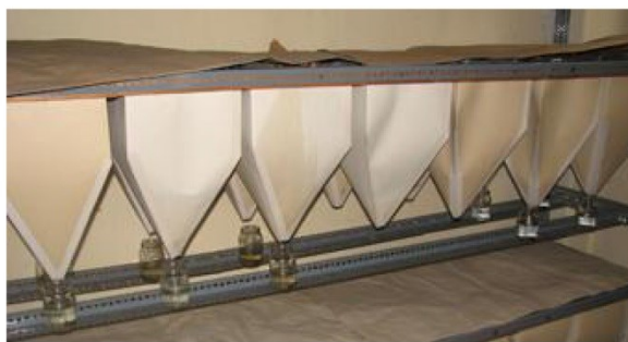
1.ábra: Papírtölcséres futtatók az MTM Állattárában. A talajállatok fokozatosan a tölcser aljára vándorolnak, ahonnan egy etanollal töltött edénybe hullnak.
