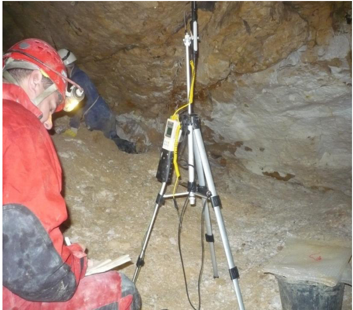
99-100. ábra: klímamérés a Csengő-teremben, Kálmán László bevonásával, 2012.-ben. A képen látható állványon hőmérséklet- és páratartalom regisztráló és szén-dioxid mérő volt rögzítve és a kis terem terhelhetőségét vizsgáltuk. A mérés időszaka alatt 3 órán keresztül több mint 10 barlangász egy pontba csoportosult, mely jelentős hőt és szén-dioxidot termelt. A teremben egy idő után konvekció alakult ki, mely a meleg levegőt folyamatosan forgatva a széndioxidot a magasabban fekvő terem-bejáraton keresztül kitolta. 2 óra elteltével gyakorlatilag egyensúlyi állapot állt be, azaz a kilélegzett szén-dioxid koncentrációja már nem növekedett tovább (fotó: Stieber Balázs)
