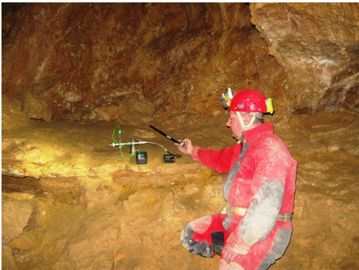
101. ábra: abszolút-nedvesség meghatározása az Agyagos-folyosóban, elektronikus-pszichrométerrel, 2014.-ben (fotó: Horváth Á. Katalin)
