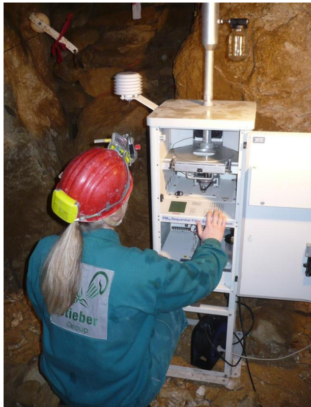
55. ábra: Thermo RAAS szekvenciális pormintavevő szekrény a barlangban
