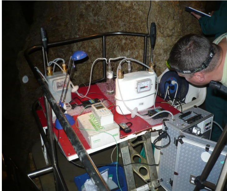
97-98. ábra: barlangi aeroszol többféle módszerrel történő mintavételezése az „Óriás-folyosó Karzatán” (fotó: Izmini Zsuzsanna)
