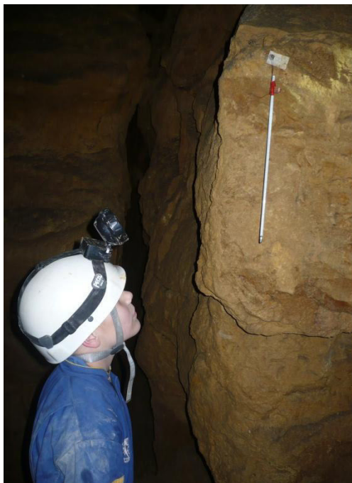
102-103. ábra: klímamérések a fiatalok bevonásával 2012-ben a barlangban. Kálmán László beépített higanyos hőmérőt olvas le az Agyagos-folyosóban, míg Stieber Balázs szén-dioxidot mér a Kadic-folyosóban (fotó: Stieber József)
