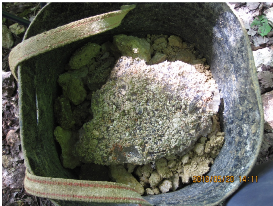
9. sz. fotó: a kitermelt törmelék jellemzően átfagyott, porózus szerkezetű mészkő (fotó: Kocsis Gergely)
