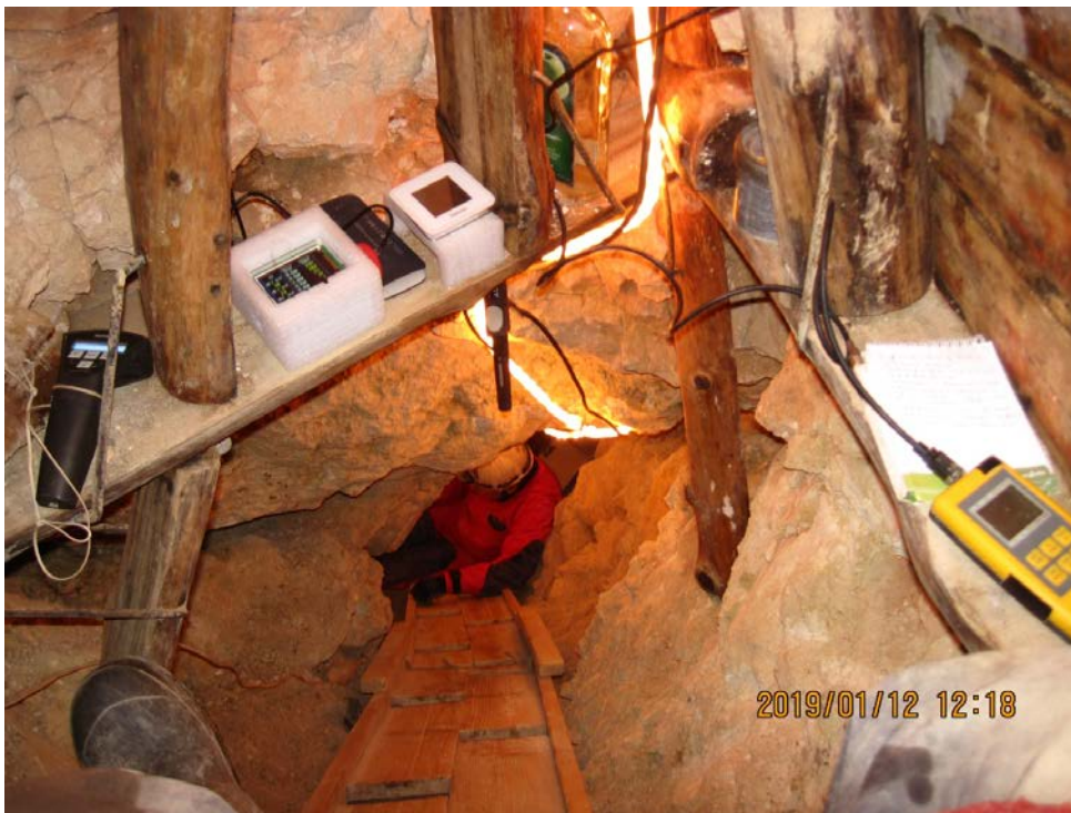
18. fotó: ideiglenes klímamérő munkahely a barlangban: gamma dóziméter, aeroszol- átmérő és eloszlás mérő, szén-dioxid mérő és precíziós hőmérő (fotó: Stieber József)
