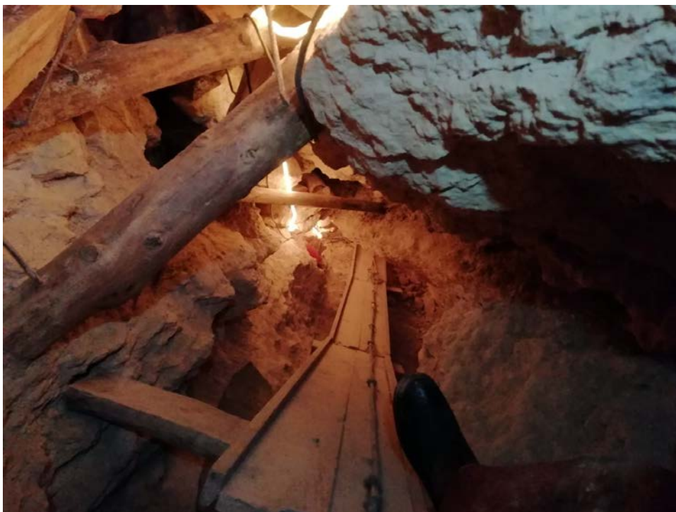
20. ábra: a végpont felé tartó kb. 30°-os lejtésű, mára már 12 méter hosszúságú, 1 méter magas járat, benne vörösfenyőből készült csúszdával, a badellák könnyebb mozgatására (fotó. Sztratiev Balázs)
