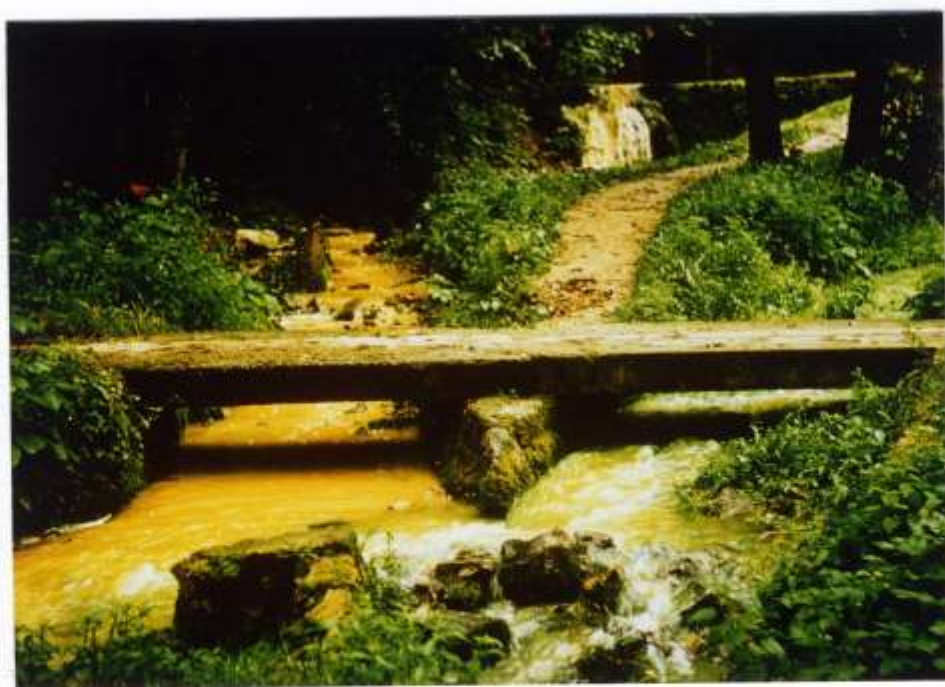
Árvizi nyomjelzés eredménye a Jósva-for- ráscsoportnál /A jobb oldali ágban jól látható a fluoreszcéines elszíneződés./
