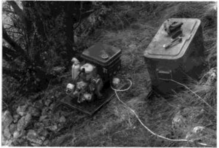
A zombolyban kibontott anyagok felszínre szállításához használt agregátor és csörlő
