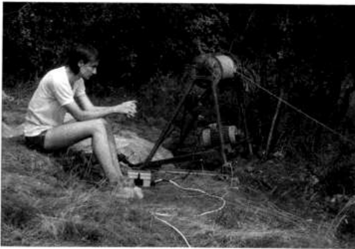
A zombolyban kibontott anyagok felszínre szállításához használt agregátor és csörlő
