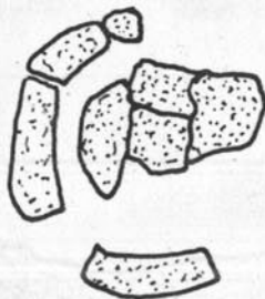
4. ábra. Egy ép kőzetmaggal rendelkező, de már kihordósodott oszlop vázlatja
