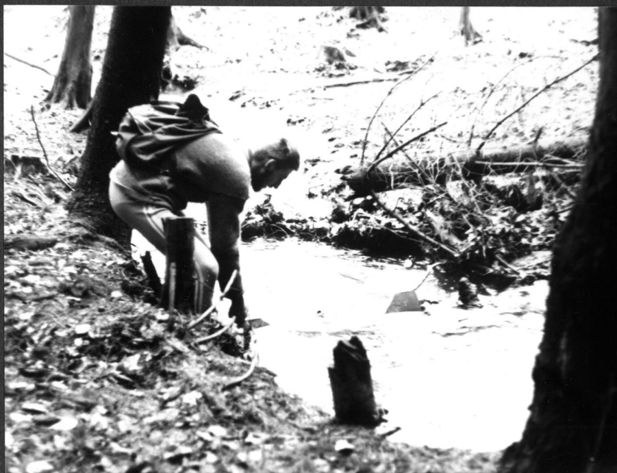
54. kép A Kis-vasuti-viznyelő árkába telepített mérőbukó.
