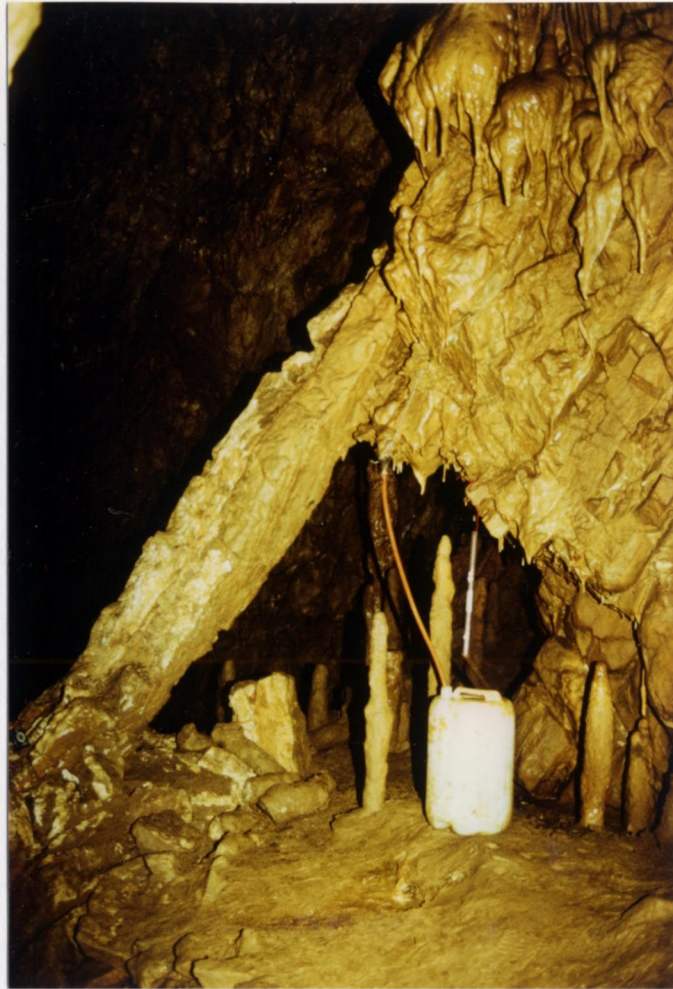
Csepegésmérő a Létrási-Vizes-barlang Kőhidas-termében (Kovács Attila)
