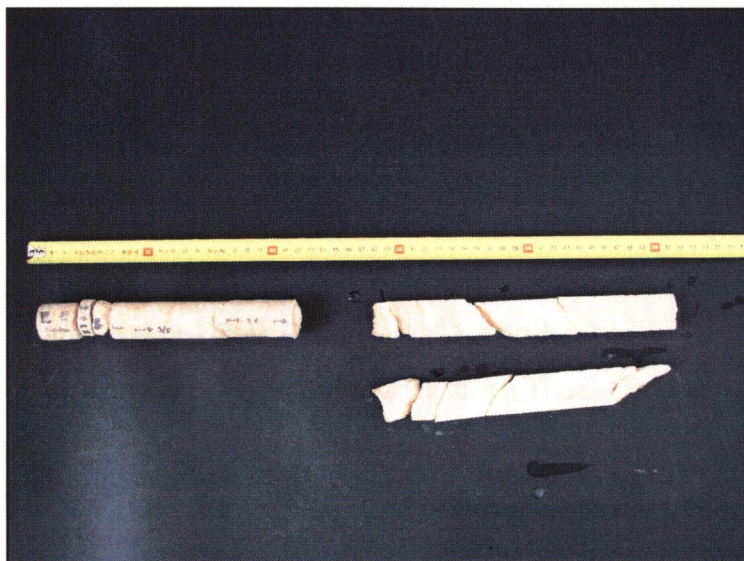
16. ábra. A Búboskemencéből vett minta félbevágott metszete
