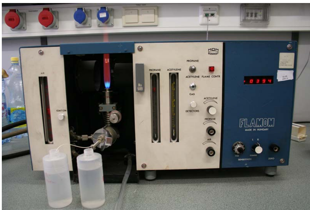
6.7 kép: Nátrium és kálium ionok mérése Flamon lángfotométerrel
