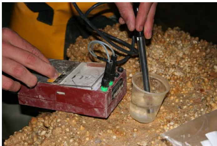
6.5 kép: Fajlagos elektromos vezetőképesség mérése a Szemlő-hegyi-barlangban
