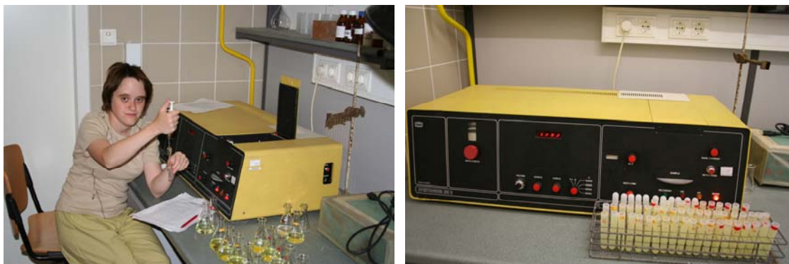
6.9 kép: Szulfát (és nitrát) mérése Spektromon 195D fotométerrel
