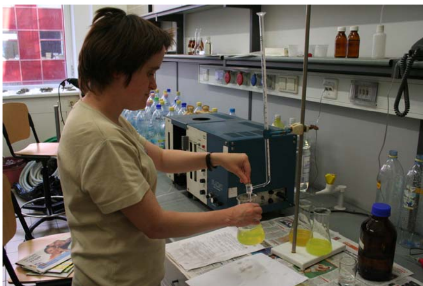
6.8 kép: Klorid (és kalcium, magnézium, hidrogénkarbonát) titrimetriás mérése
