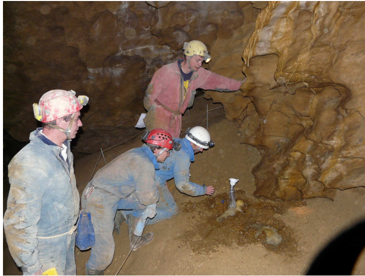
12. ábra: A Bekey Imre Gábor Barlangkutató Csoport tagjai csepegésmérő edényt helyeznek el a Pálvölgyi-Mátyáshegyi-barlangrendszerben (Fotó: Sőregi I., 2009)
