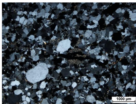
6. kép: 5. számú kavics mikroszkópos felvétele (+N)
