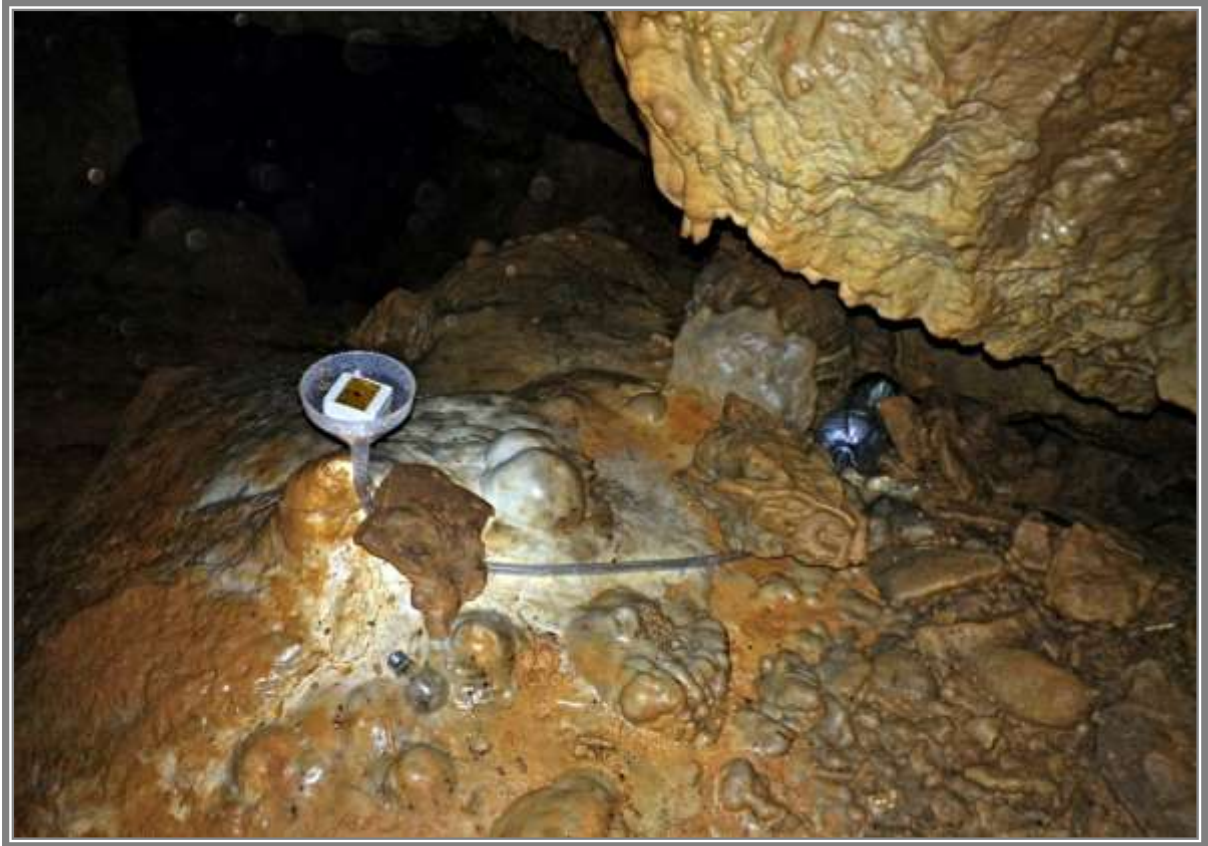
Mintavételi pont csepegés intenzitás mérővel
