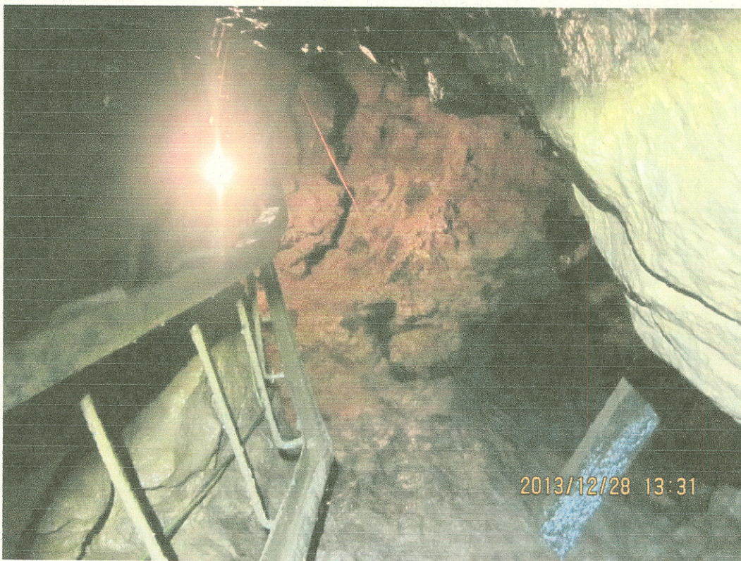
1. sz. fotó (készítette: Stieber József) A fényképen jól látszik az aknába beépített szállítópálya és a 24 V-os járatvilágítás, mely a kutatás biztonságát szolgálja
