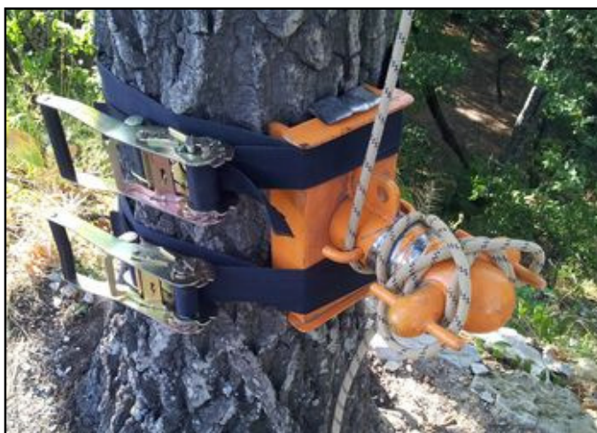
6. kép: Az új vödörleeresztő-fékünk ( Kugyela L. )
