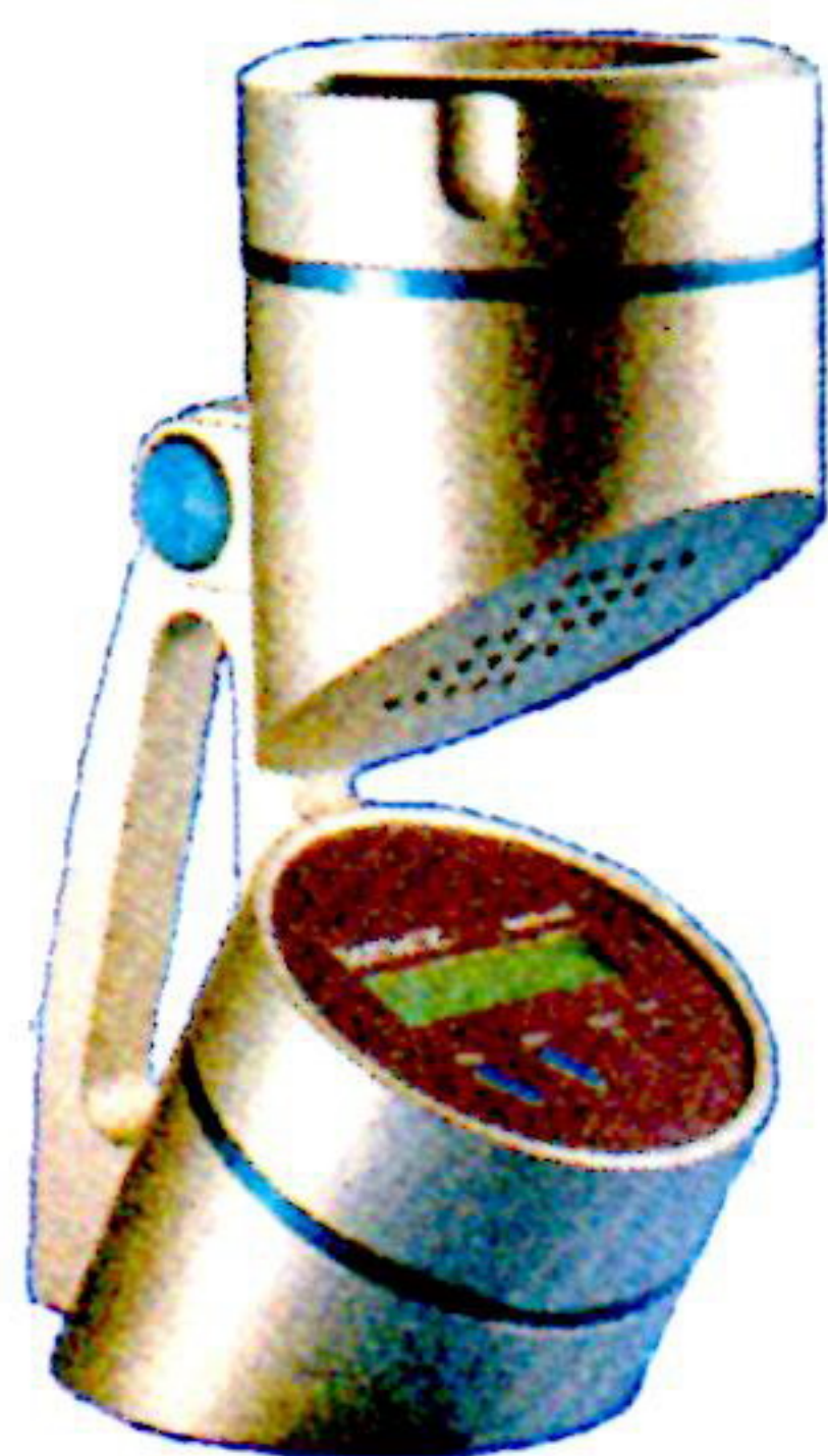
1.kép: MERCK MASS-100-as levegő mintavevő berendezés
