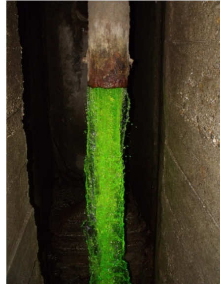
Fluoreszcein injektálása és detektálása
