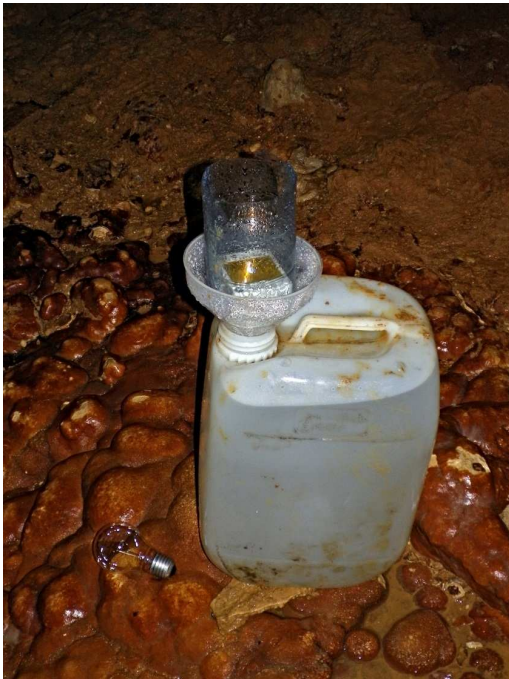
A Vörös-terem A pontján kihelyezett mérőedény műszerrel és kalcitnövekedést vizsgáló villanykörtével
