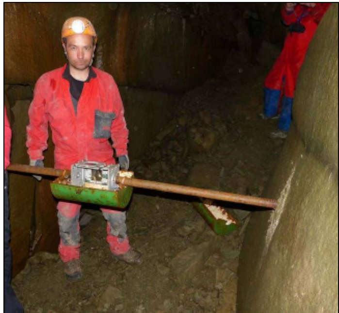
A sziklatömbök elmozdulását mérő szerkezet (Sz. Gy.)
