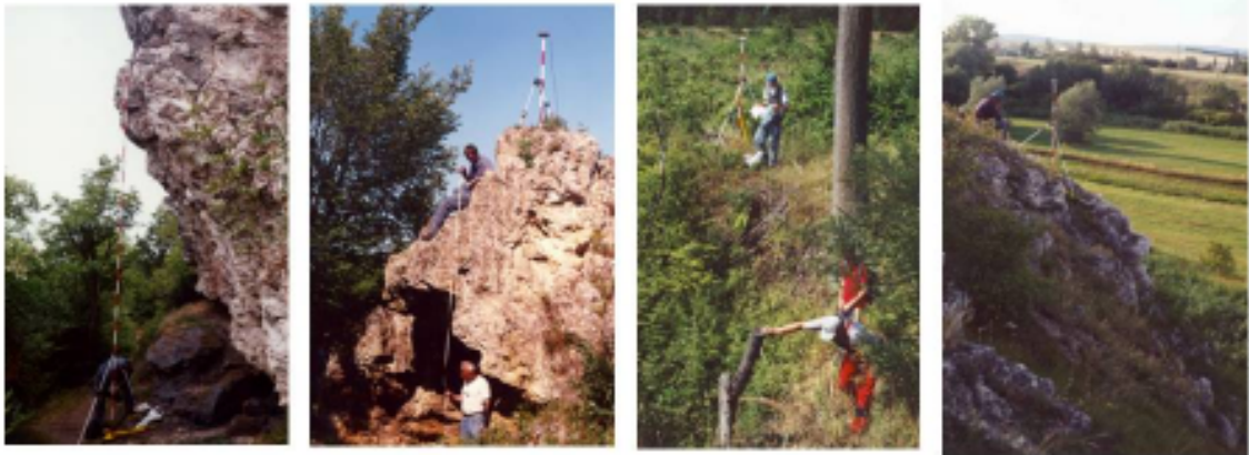
3. ábra Hat méter magasra kiemelt antenna Tihanyban a Nyereg-hegyi-eresznél (balra), magassági külpontosság Tihanyban a Szarkád-tetői-barlangnál (balról a második), vízszintes külpontosság Balatonedericsen a Kessler Hubert-barlangnál (balról a harmadik), vízszintes és magassági külpontosság Hajmáskéren az Andrej-barlangnál
