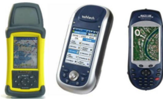
2. ábra Hemisphere Crescent (balra), Astech (középen) és Magellán (jobbra) EGNOS-korrekciók vételére alkalmas térinformatikai GNSS-vevők
