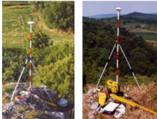
1. ábra Leica 500-as (balra) és Trimble ProXR vevő (jobbra) gyors statikus mérés közben
