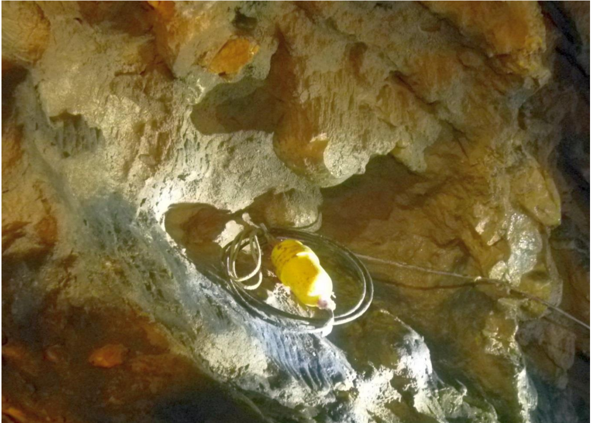
3. ábra: A vízszintregisztráló műszer adatkábélének vége egy vízálló tokban (Fotó: Szerencsi Judit)
