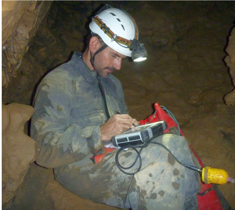
7. ábra: A kiolvasó műszer és az adatkábelt védő sárga tok (Fotó: MFGI)
