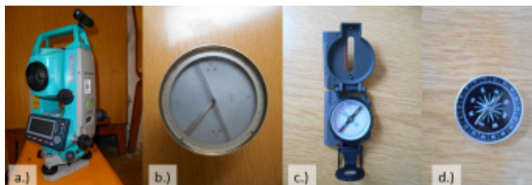
2. ábra A Sokkia SET 230 RK mérőállomás csőbusszolóval (a), a Süss-féle tájoló (b), a Quechua C100 busszola (c) és az egyszerű tájoló (d)
