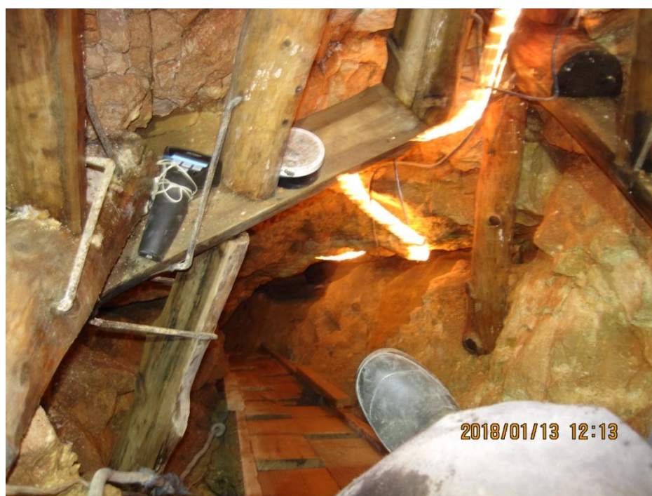
9. sz. fotó: Háttérsugárzás és barlangi-levegő hőmérsékletének mérése a ferde-akna bejáratában. (Fotó: Stieber József)
