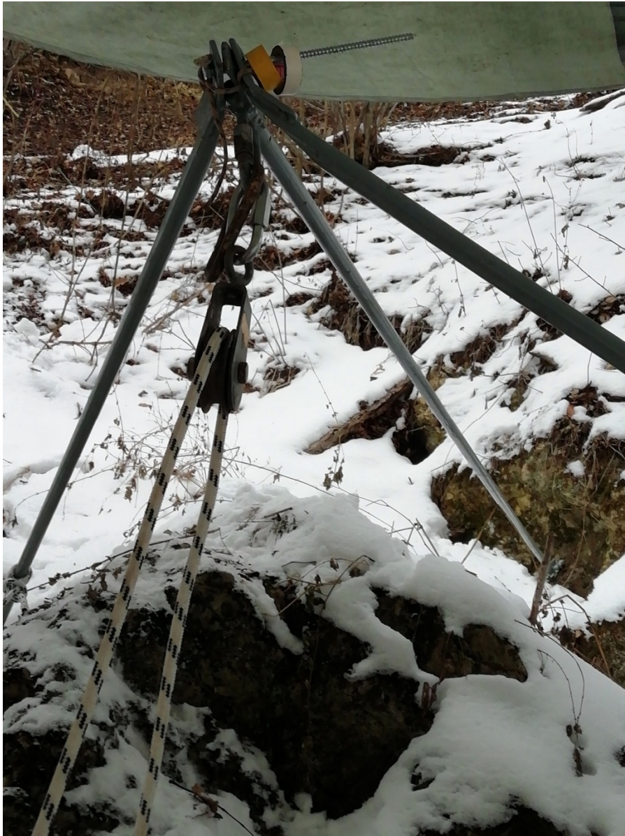
10. sz. fotó: Könnyen telepíthető 3 lábú kézicsörlő-állvány az anyagmozgatás megkönnyítésére, a barlang bejáratában. (Fotó: Kocsis Gergely)
