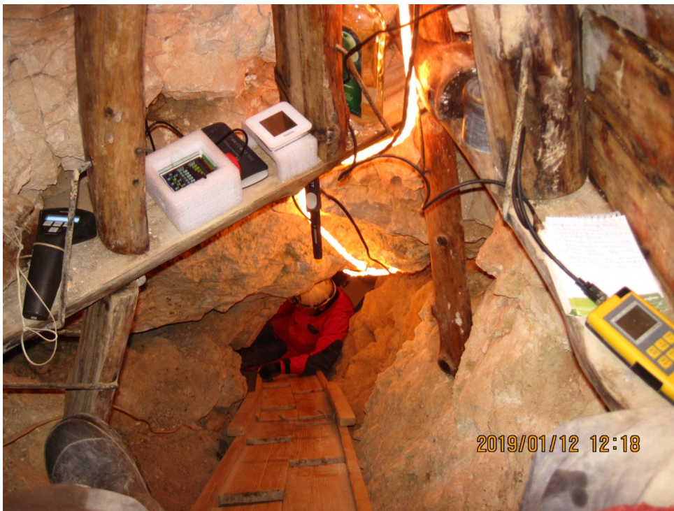
18. fotó: ideiglenes klímamérő munkahely a barlangban: gamma dóziméter, aeroszol- átmérő és eloszlás mérő, szén-dioxid mérő és precíziós hőmérő (fotó: Stieber József)
