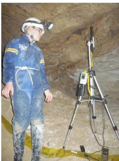
99-100. ábra: klímamérés a Csengő-teremben, Kálmán László bevonásával, 2012.-ben. A képen látható állványon hőmérséklet- és páratartalom regisztráló és szén-dioxid mérő volt rögzítve és a kis terem terhelhetőségét vizsgáltuk. A mérés időszaka alatt 3 órán keresztül több mint 10 barlangász egy pontba csoportosult, mely jelentős hőt és szén-dioxidot termelt. A teremben egy idő után konvekció alakult ki, mely a meleg levegőt folyamatosan forgatva a széndioxidot a magasabban fekvő terem-bejáraton keresztül kitolta. 2 óra elteltével gyakorlatilag egyensúlyi állapot állt be, azaz a kilélegzett szén-dioxid koncentrációja már nem növekedett tovább (fotó: Stieber Balázs)
