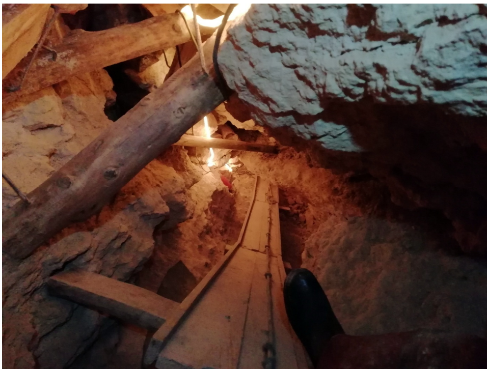
20. ábra: a végpont felé tartó kb. 30°-os lejtésű, mára már 10 méter hosszúságú, 1 méter magas járat, benne vörösfenyőből készült csúszdával, a badellák könnyebb mozgatására (fotó. Sztratiev Balázs)
