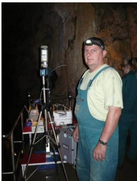
97-98. ábra: barlangi aeroszol többféle módszerrel történő mintavételezése az „Óriás-folyosó Karzatán” (fotó: Izmini Zsuzsanna)
