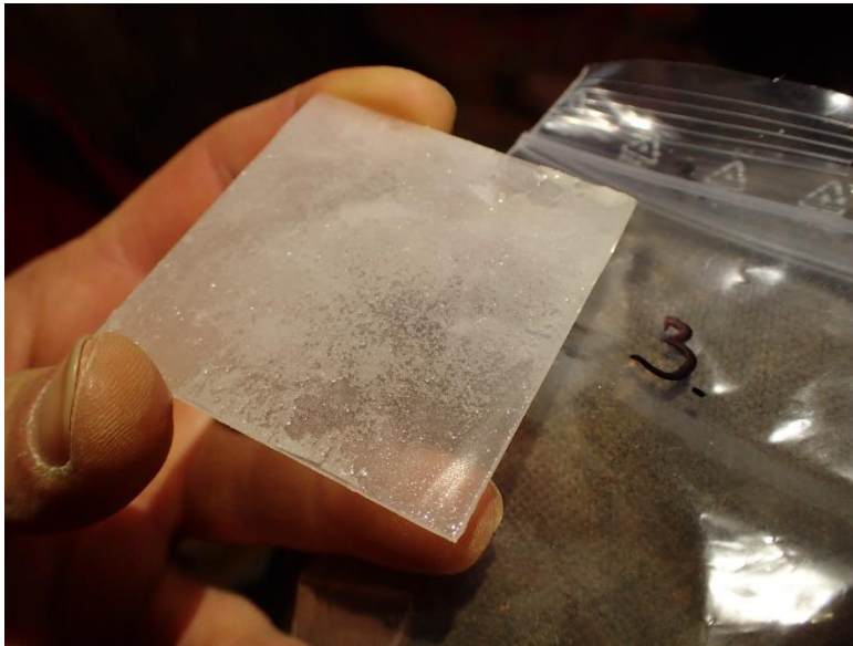
10. ábra: A Rózsát-termi vízmintavételi hely csepegésintenzitás-mérőjére kihelyezett üveglap.
