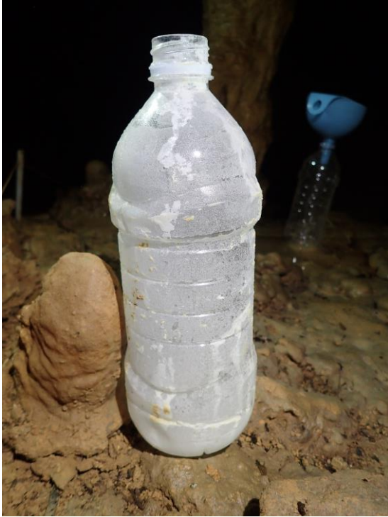
8. ábra: A csepegővíz gyűjtése céljából kihelyezett flakonon, mindössze 3 hónap alatt kivált karbonát (Vacska-barlang Rózsát-terme). A Pilisben nem tapasztalható ehhez hasonló intenzitású karbonátosodás. Ezt látva döntöttünk úgy, hogy üveglapokat helyezünk a csepegések alá, hogy lehessen belőle következtetni a karbonátkiválás gyorsaságára.
