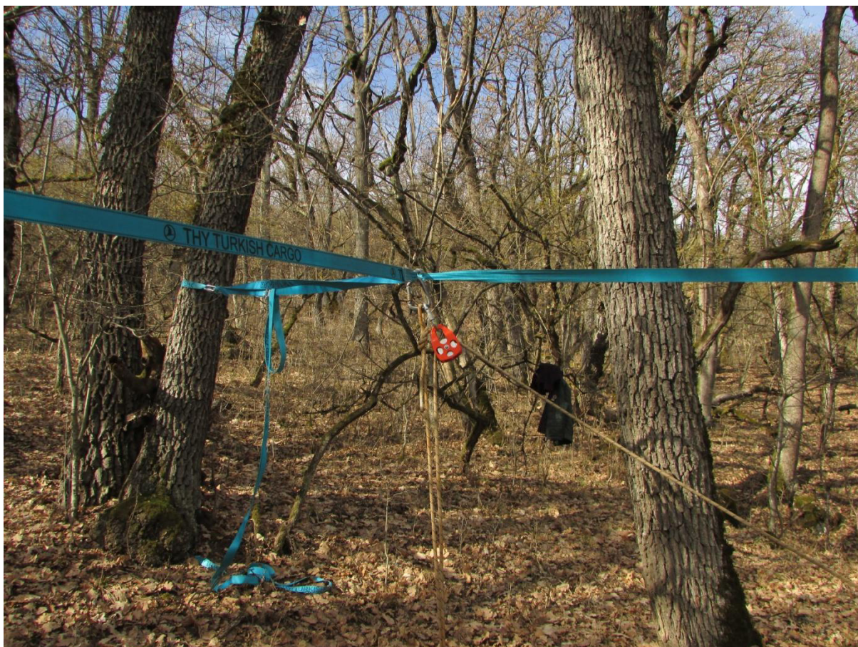
2. kép Három fa közé feszített hevederrendszerhez rögzített felhúzórendszer
