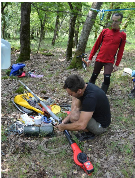
3. kép Lombfűvós szellőztetőrendszer összeszerelése
