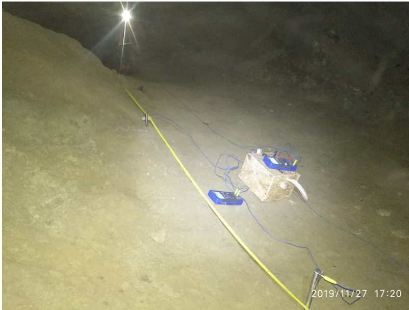
Talajellenállásmérés a Kincses-teremben (foto: Kudlik Dávid)
