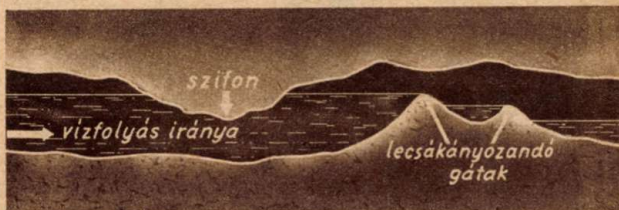
A vízszintsüllyesztéssel megszüntethető szifon típusa
