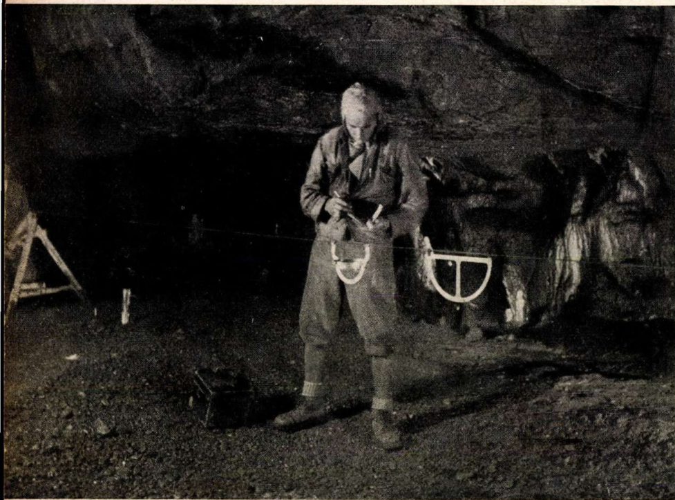
Pontos hosszsmérés barlangban feszített zsinóron. A zsinóron függőkompass és foklív
