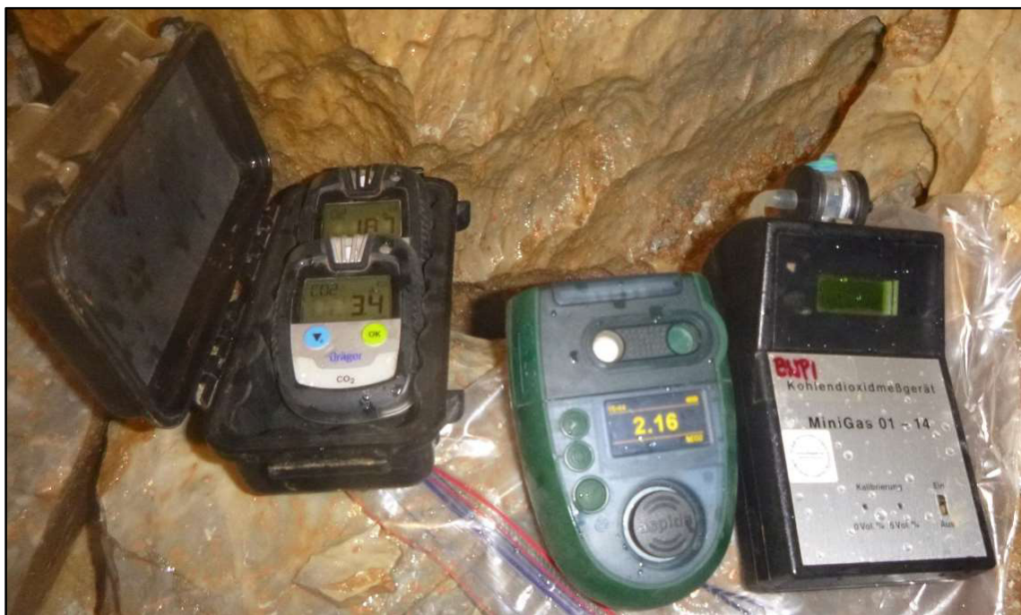
12. fotó: Szén-dioxid-mérő-kézi készülékek a Tetőfelújítás talpán. (Mindegyik jelentős eltérést mutat.)
