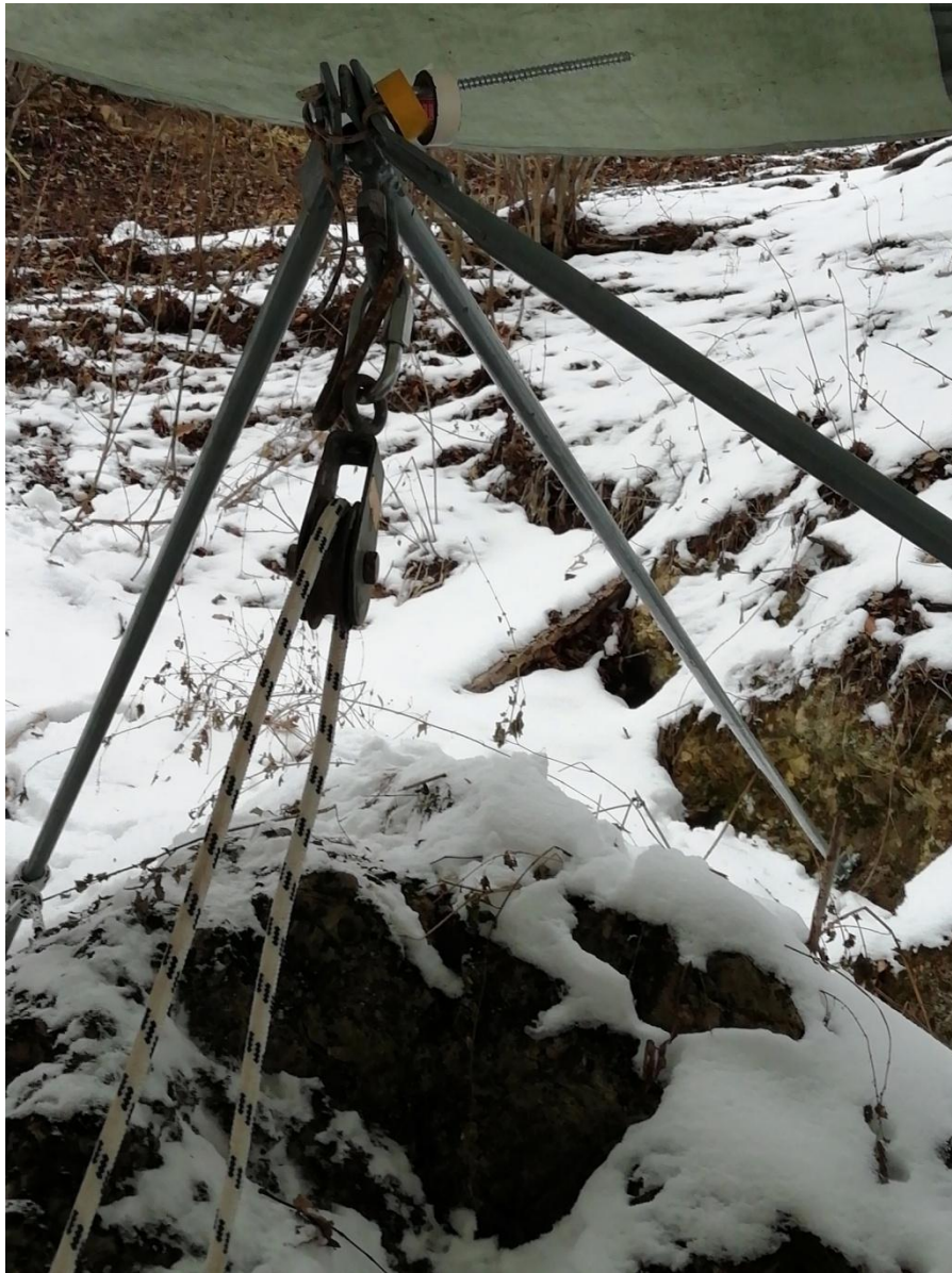
6. sz. fotó: Könnyen telepíthető 3 lábú kézcserlő-állvány az anyagmozgatás megkönnyítésére, a barlang bejáratában. (Fotó: Kocsis Gergely)
