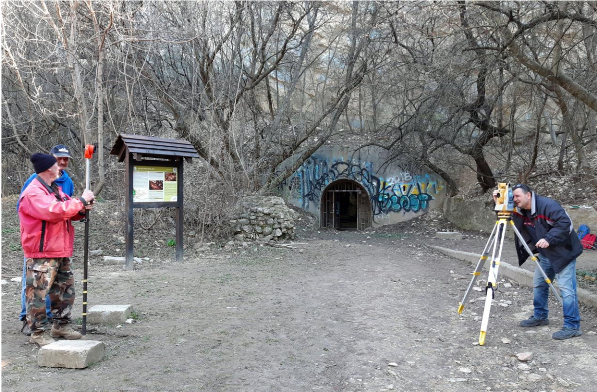
51. ábra: Az excenter bemérése (MBFSZ, 2020. 03. 12)
