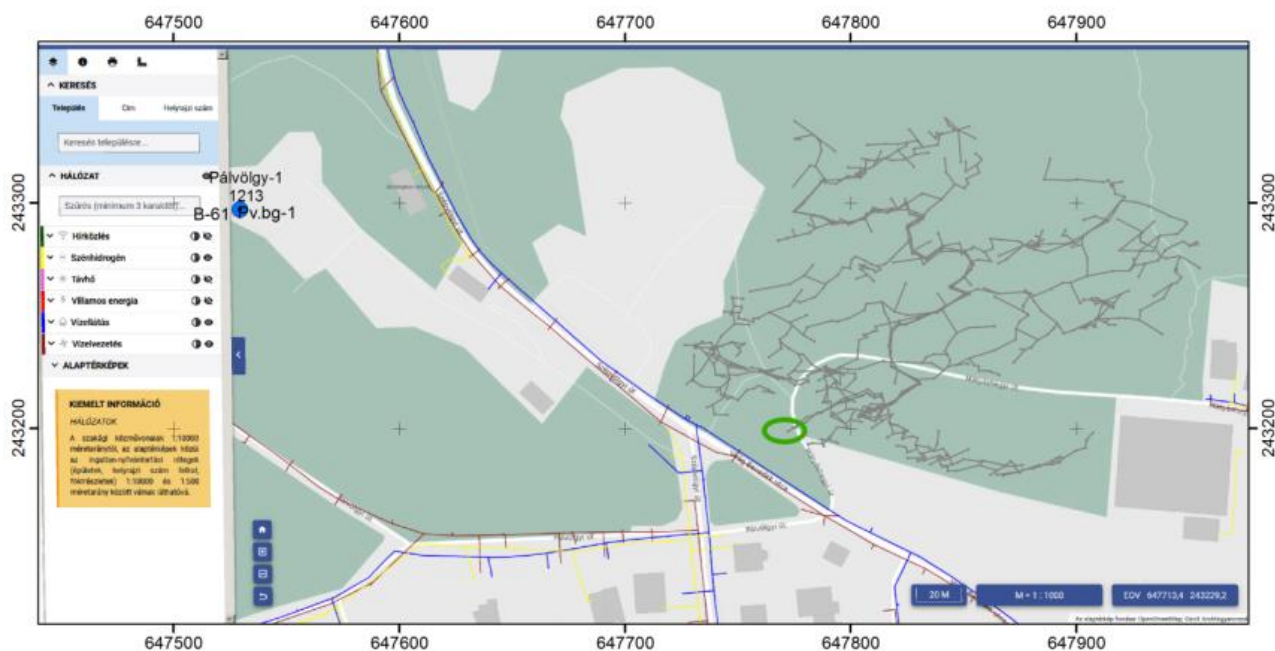
13. ábra: A gáz- és vízvezetékek a Mátyás-hegyi-barlang környezetében az e-Közmű felületén
