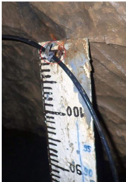
47. ábra: A mérőlécc és a műszer (fotó: MBFSZ)
