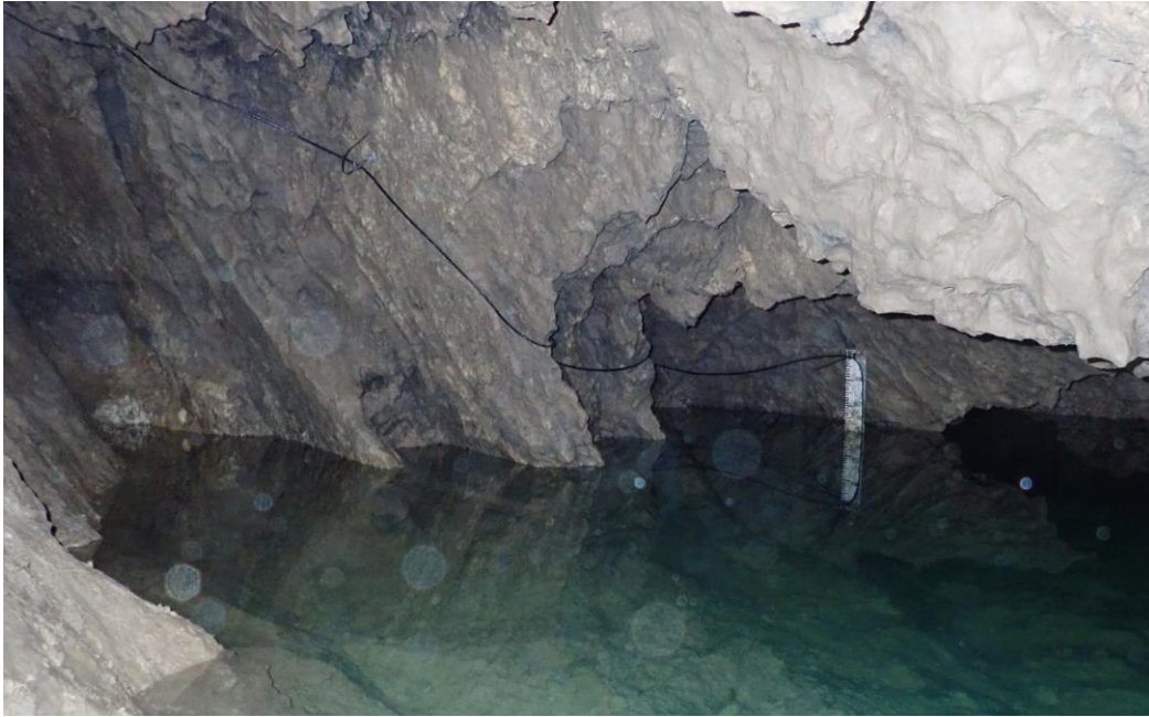
8. ábra: A 2016-tól működő Dataqua műszer a vízszintmérőléccel (foto: Borzsák S.)
