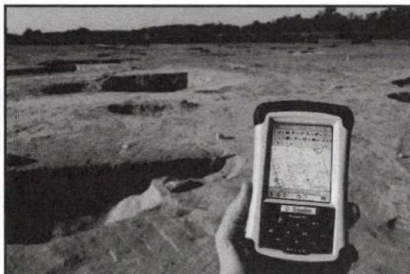
Modern, nagy pontosságú GPS és terepi számítógép segítségével az ásatáson is használhatjuk a már elkészült térképeinket. Újabb pontokat rögzíthetünk, amelyeket kiegészíthetünk a szükséges régészeti adatokkal
