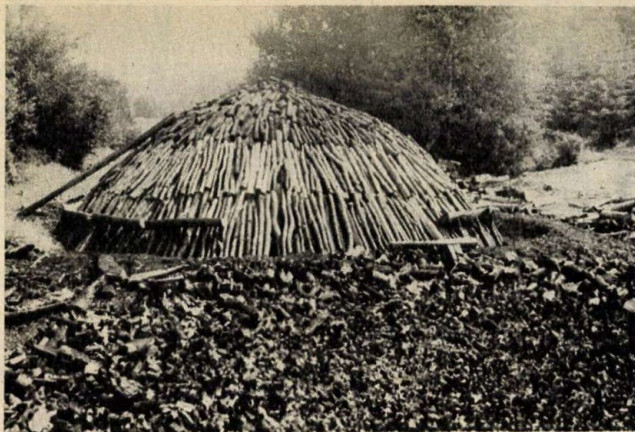
Továbbra is fennmaradó ősi mesterség a faszénégetés. A nagy gonddal összerakott szénégető boksa (A szerző felvételei)
