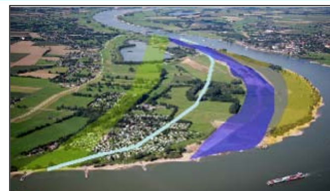
2. ábra: Öt alternatíva a bukógátra és az alacsonyabb ártér kialakítására
