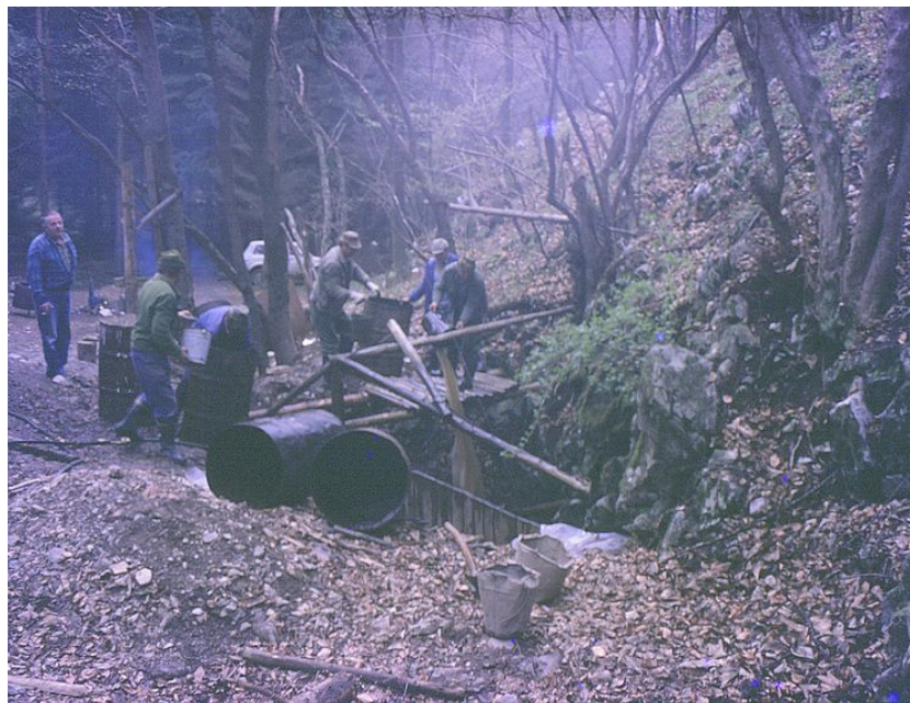
47.ábra. NaCl oldat adagolása a Hármasküti-víznyelőbe (Fotó SZILÁGYI F.)
