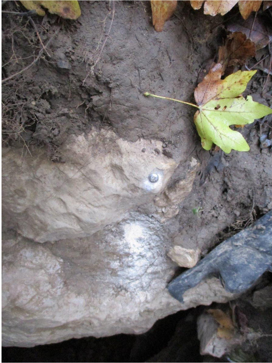
Rozsdamentes lemezcavar használata mint fix polygonpont
