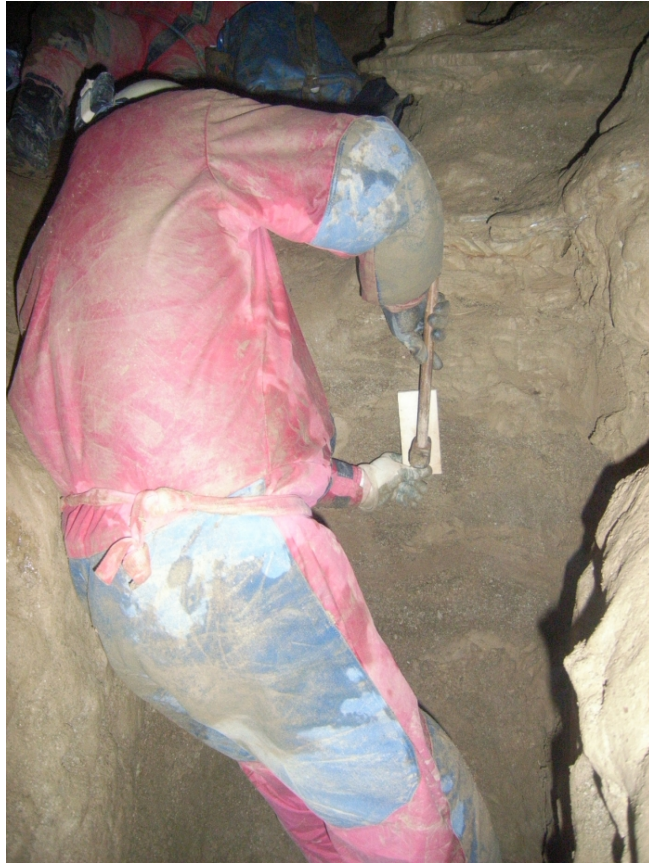
8. ábra. Az első üledékgyűjtő cső beütése a rétegsorba, falpkával védve a mintavevő csövet
