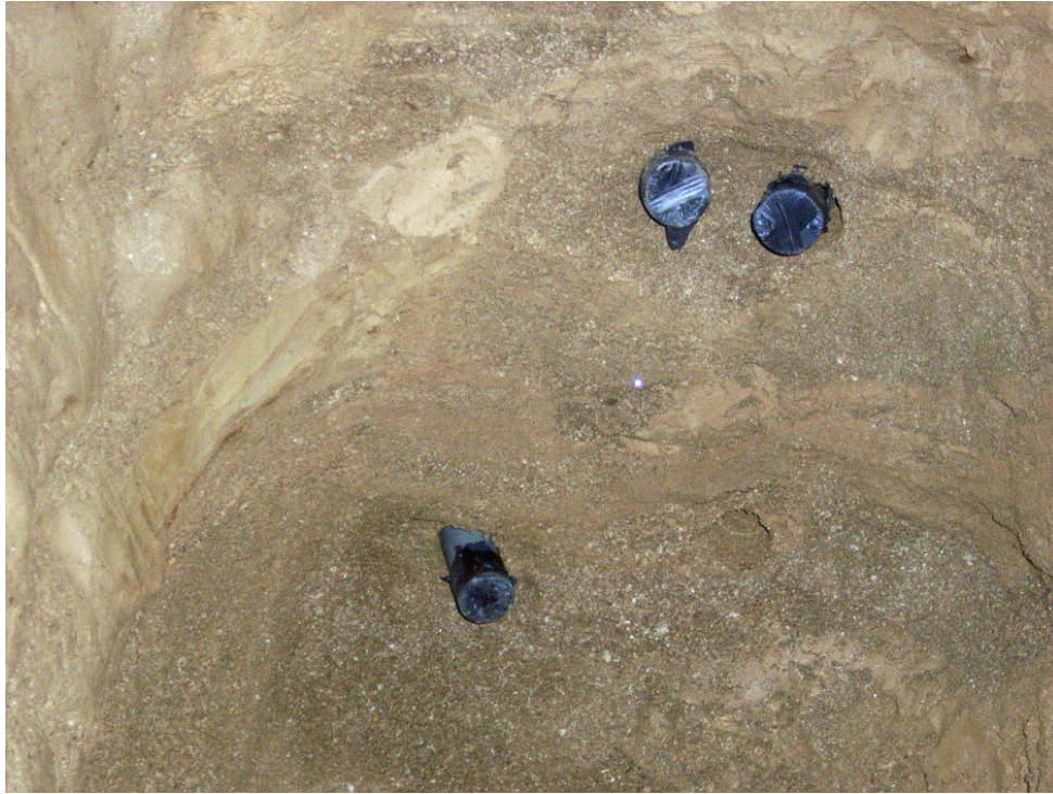
14. ábra. A még nem teljesen beütött mintavevő csövek a rétegsorban
