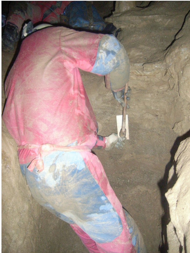
13. ábra. Az első üledékgyűjtő cső beütése a rétegsorra, falapkával védve a mintavevő csövet
